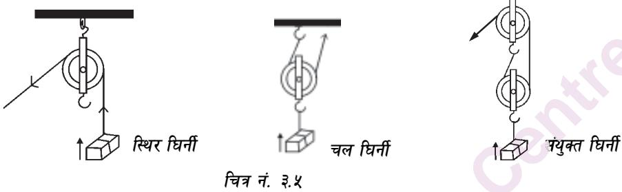
(ख) चल घिर्नी (Movable pulley) : वरिपरि घुम्नुका साथै लोडसँग तलमाथि चल्ने घिर्नीलाई चल घिर्नी भनिन्छ । यस्ता घिर्नीहरू धेरै गरौं लोडलाई उठाउन प्रयोग गरिन्छ ।
